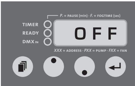
Abb. 4: Display-Anzeige beim Ausschalten des Gerätes
